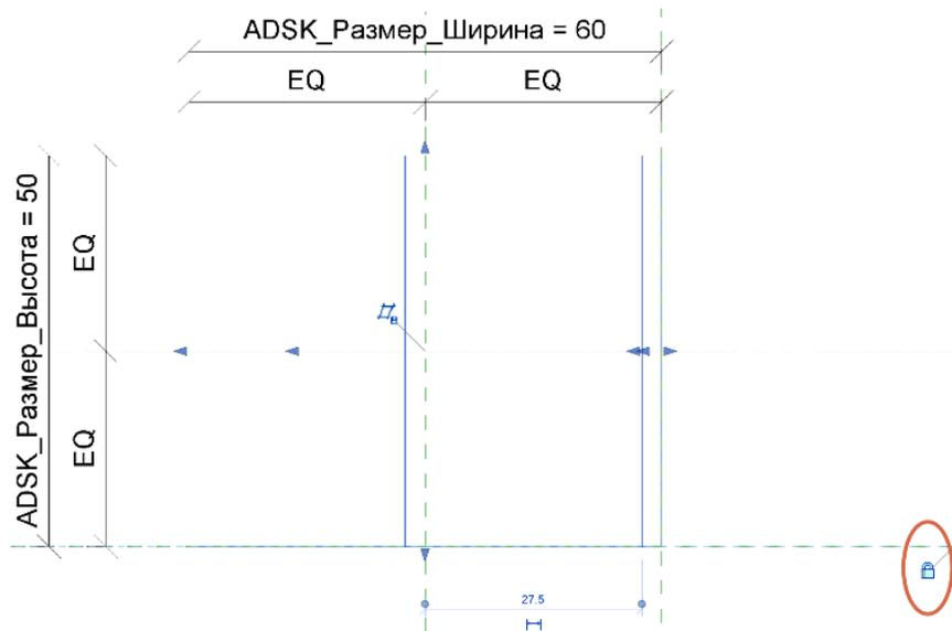
Рисунок А18 – Привязка грани кронштейна к опорным плоскостям
